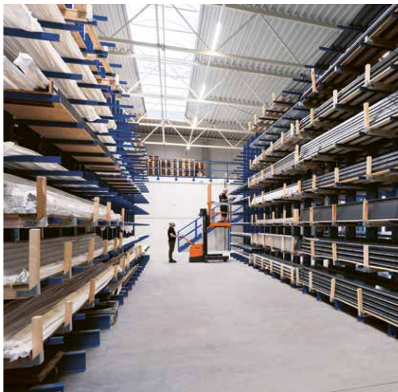
Kragarmregale dienen zur Lagerung von langen und sperrigen Lagergütern wie Rohren, Stangen oder Platten.
